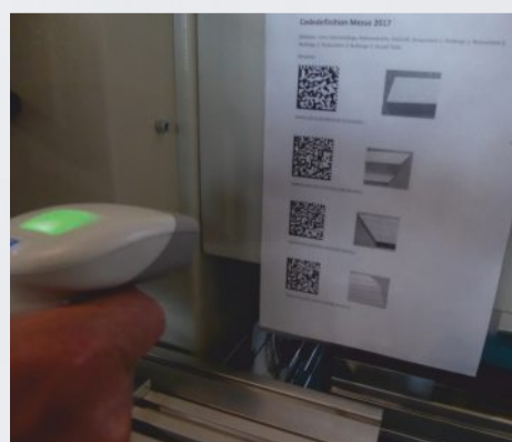
Barcodeleser (QR) zur automatischen Positionierung der Werkstücke sowie der Bearbeitungsaggregate
